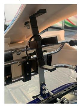
2) Posizionare la batteria nell'alloggiamento e bloccarla con il nastro rosso fornito.
