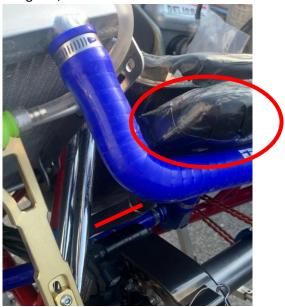
2) Disporre il cablaggio in maniera uniforme facendo arrivare i connettori negli opportuni punti del telaio;
